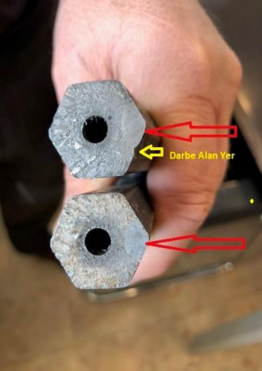
Resim 1: Dışarıdan Aldığı Darbe Sonucu Delme İşlemi Sırasında Kırılan İntegral Matkap
